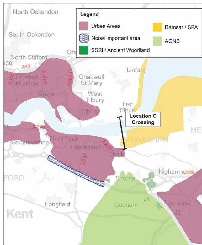
**FIGURE 2.8 - CROSSING LOCATION SHOWING URBAN AND ENVIRONMENTAL CONSTRAINTS**
